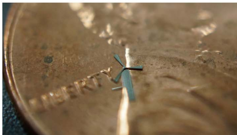
En mikro-vindmølle som er montert på en amerikansk "nickel" (5 cent-mynt). Mynten har en diameter på 21,21 mm. (Foto: Uta.edu)
