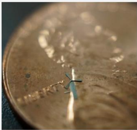
Hier sieht man ein Mikrowindrad auf einer 1-US-Cent-Münze (19,05 mm Durchmesser). Bildquelle: Uni Texas, Arlington.
