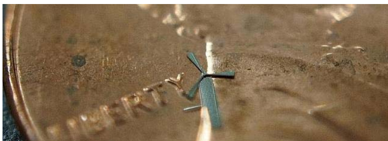
Uno de los micro-molinos instalados en una moneda de penique. UTA
